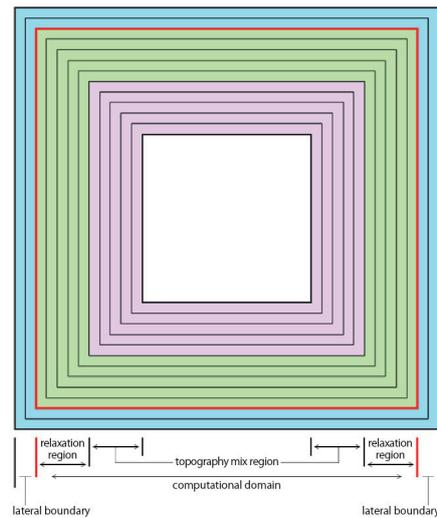
図 5.4: 地形コピーを適用した子ドメインの地形データ水平分布. 最外の水色の 2 層は側面境界で、それより内側の赤色の線で囲われた領域が計算領域である。緑色の部分がバッファ領域、桃色の部分が地形遷移領域、そして最内の白色の部分が子ドメインの地形をもつ領域である。地形遷移領域では外側から内側にかけて徐々に親ドメインの地形データから子ドメインの地形データへ遷移する。
