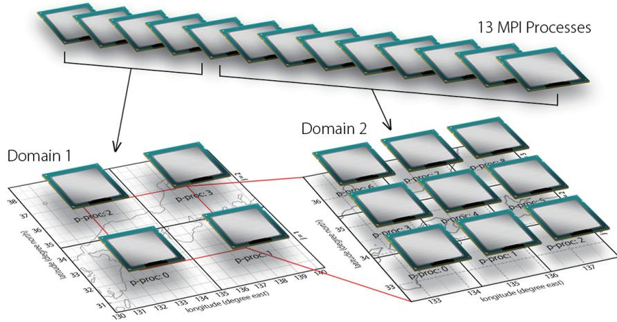
図 5.3: オンライン・ネスティング実験の MPI プロセス配分イメージ. 全部で 13 のプロセスを立ち上げ、これを適切に分配することで、Domain 1 は  $2 \times 2$  の 4-MPI 並列、Domain 2 は  $3 \times 3$  の 9-MPI 並列計算を行う。Domain 1 から Domain 2 へ MPI 通信によってデータを受け渡ししながら時間積分計算を進める。
